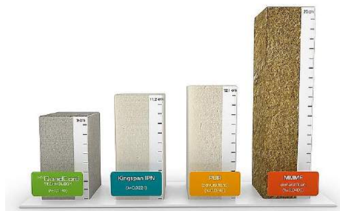
3.attēls. Nepieciešamais paneļa biezums, lai sasniegtu U vērtību 0,20 \text{ w/m}^2\text{K} [17.,19.lpp]
